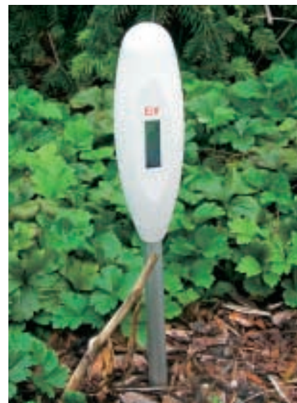
Ein Funk-Aussensensor der Wetterstation mit Mini-Solarpanel.
